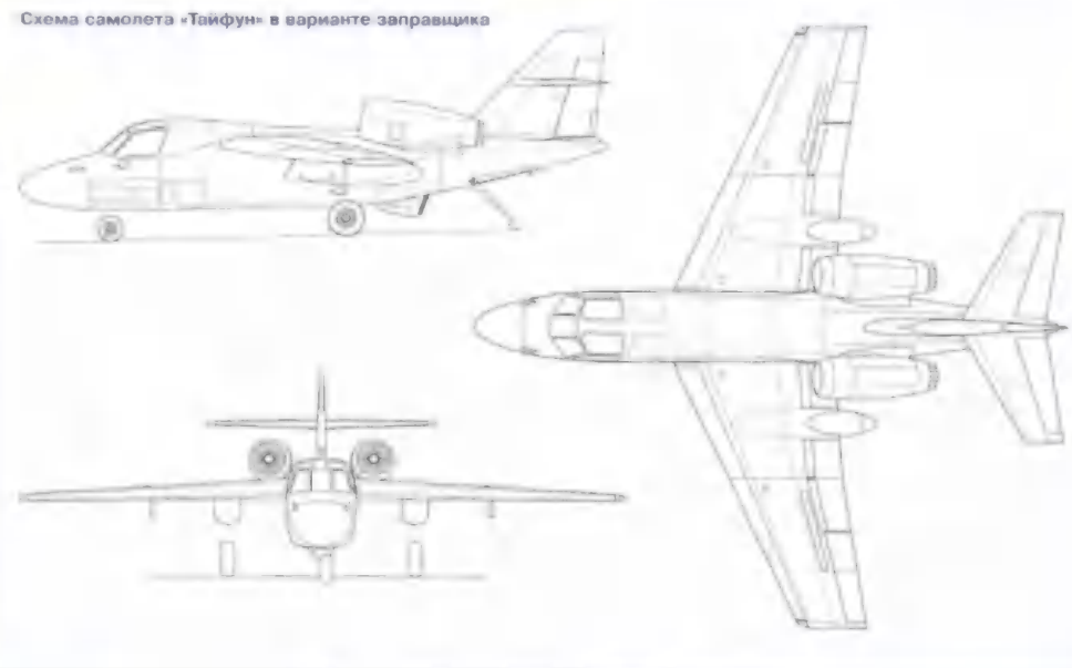
Схема самолета «Тайфун» в варианте заправщика
